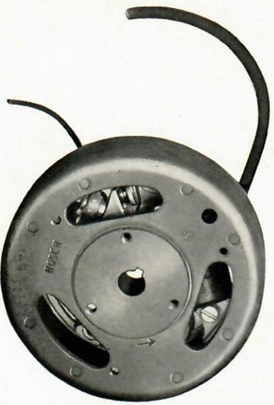
Bild 3 Bosch-Schwungmagnetzündler MZ/UKB 1/102 L 2
